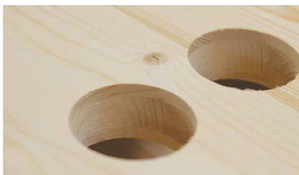
Usinage des ouvertures des formes différentes
