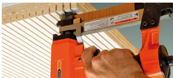
Pistolet à air comprimé avec un manchon de fermeture étroit (Reich).
