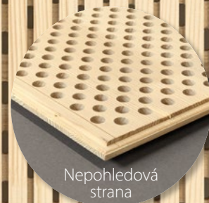
Profil S/L – côté de qualité visible rainure 4/12, côté de qualité non-visible perçage 16/32-32 Essences de bois : uniquement sapin
