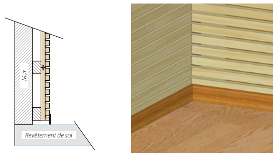
Détail de la finition par un tasseau
